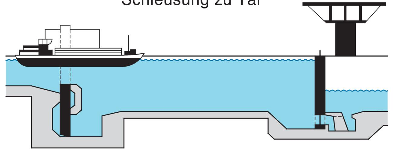
Füllung der Schleusenkommer durch Anhebung des Hub-/Senktores
